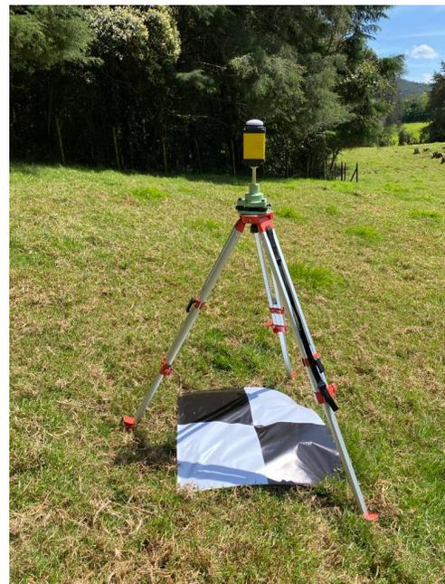
*Figura 2. Levantamiento fotogramétrico en campo.*
