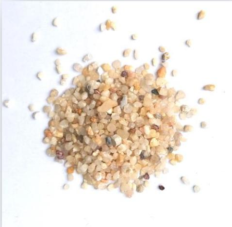
**Figura 4.** Arena de sílice utilizada en el experimento
