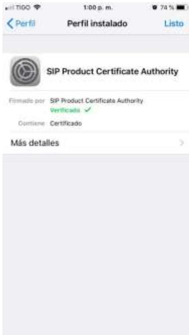
Una vez instalado aparecerá el siguiente pantallazo, presionamos en **listo** y validamos que haya quedado el certificado instalado, regresando a la opción de perfil.
