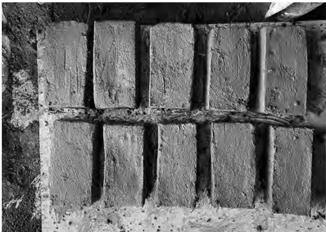
**Figura 7.14** Desmolde y secado
